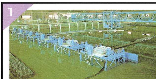
■潮流・波浪実験水槽 (61.0m×48.5m×1.5m)
